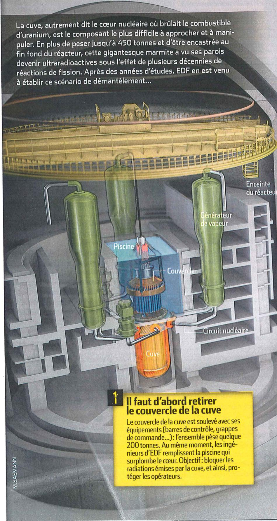
**1 Il faut d’abord retirer le couvercle de la cuve**
