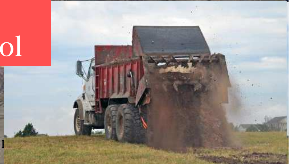
Déchets de forage, en Oklahoma, répandus sur des terres agricoles auxquelles est donné le nom de « soil farm », ferme à terre..
