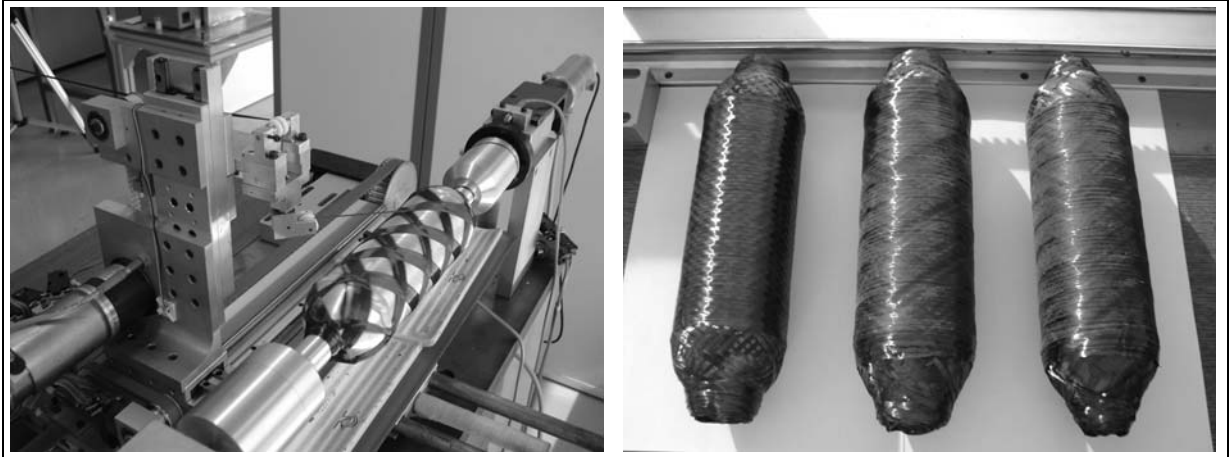
Figure 1 : photographies de stocks d'hydrogène 700 bar [7, 8]. a) banc de bobinage croisé de la fibre de carbone, b) réservoirs après polymérisation de la résine.
